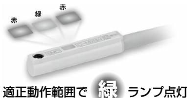
2色表示の場合、適正動作範囲(緑表示領域)に固定した場合でも、設置環境・外乱の影響で、不安定な動作をする場合があります。(磁性体、外部磁界、磁石内蔵シリンダ・アクチュエータの近接設置、温度変化、その他稼働中の磁力変動要素など)
